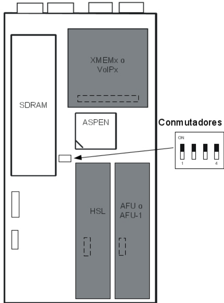
Figura 2.21 : Posición de la placa secundaria en CPU 1, CPU 2 o CPU 3
