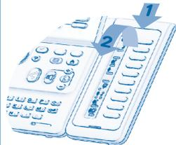
El teléfono puede estar equipado con una caja de extensión. Así dispondrá de teclas adicionales configurables como teclas de función, teclas de línea, teclas de llamada, etc. **Para colocar las etiquetas:** tire hacia usted de la lengüeta de soporte de la cubierta de las teclas y levante esta última. Sitúela la etiqueta bajo el bloque de teclas, en el lugar previsto a tal efecto y vuelva a colocar en su sitio la cubierta.
