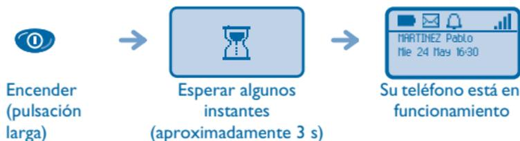
Si la pantalla no se enciende o si el icono del nivel de batería parpadea, recargar la batería.
