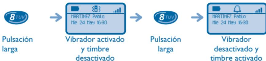
Esta tecla permite pasar rápidamente del timbre al vibrador y viceversa.
