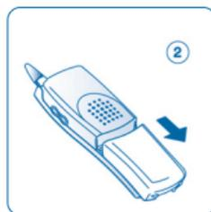
Deslizar la batería hacia la parte inferior del teléfono
