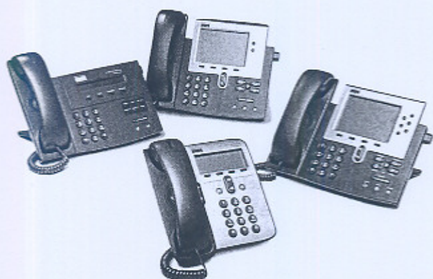
Figura 15.4. Terminales HW VoIP.
