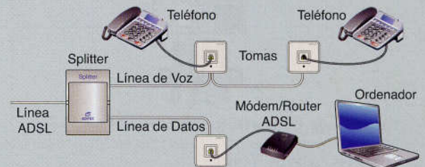
↑ Figura 1.75. Instalación de un splitter.
