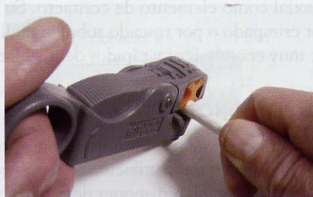
↑ Figura 4.65. Detalle de uso de la herramienta de pelado de cabeza Intercambiable.
