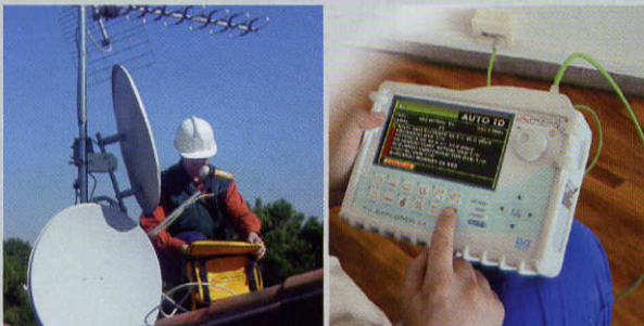
↑ Figura 4.89. Uso del medidor de campo (Promax).
