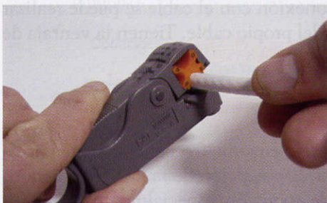
↑ Figura 4.65. Detalle de uso de la herramienta de pelado de cabeza Intercambiable.
