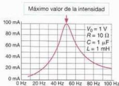
Fig. 5.29. Frecuencia de resonancia.
