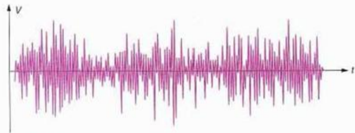
Figura 5.1. Señal acústica recogida por un micrófono.
