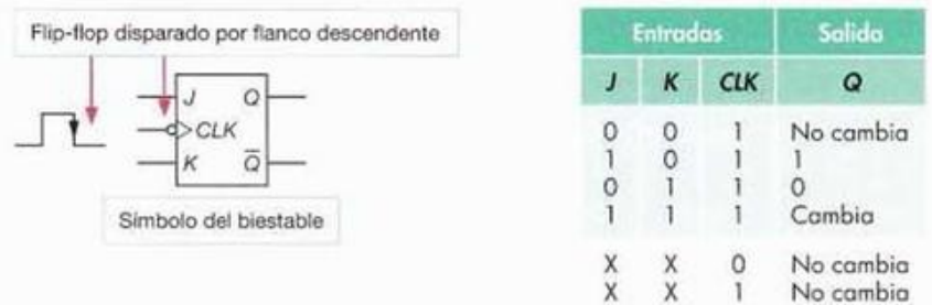
Fig. 14.12. Símbolo y tabla de verdad de un biestable JK activado por flanco de bajada.
