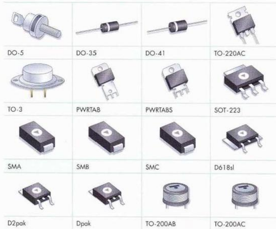
Fig. 7.40. Ejemplos de los principales encapsulados para diodos.
