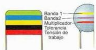
Fig. 2.33. Marcado por código de colores. El valor obtenido de la resolución del código viene dado en picofaradios ( 10^{-12} F). En algunos casos el código viene marcado por las dos caras del condensador.
