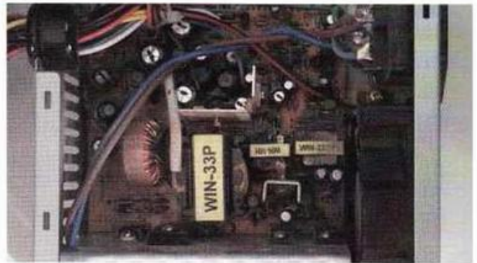
Fig. 11.23. Fuente de alimentación conmutada del monitor de un ordenador.
