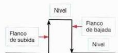
Fig. 14.8. Representación de los flancos en una señal de reloj.
