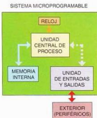
Fig. 16.1. Estructura de los sistemas microprogramables.
